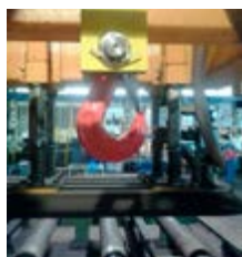
Portalni žerjav, pripravljen z novimi konzolami
