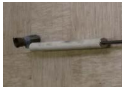
Merilna sonda je pripravljena za zajem taline in izvedbo meritev.
