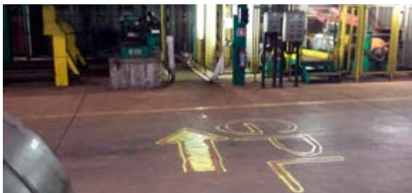
Talne oznake na intervencijski poti v hali B za brusilni stroj GPL
