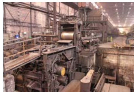
Hladni navijalnik na valjajski liniji štekla, ki ga čaka temeljita prenova
