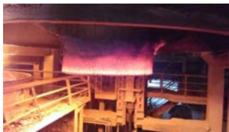
Uspešen test novega pokrova za izvajanje oksidacije nerjavnih jekel na VOD-u
