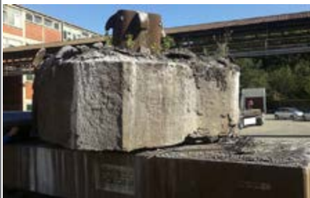
Ena izmed dveh »svinji«, pripravljena za pretaljevanje
