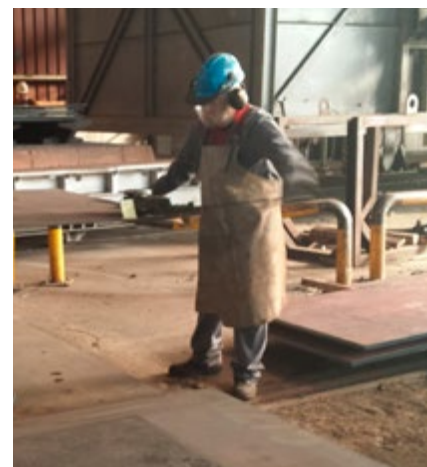
Ročno brušenje robov plošč s kotno brusilko, obrat Predelava debele pločevine (na fotografiji Nihad Turkušić)
